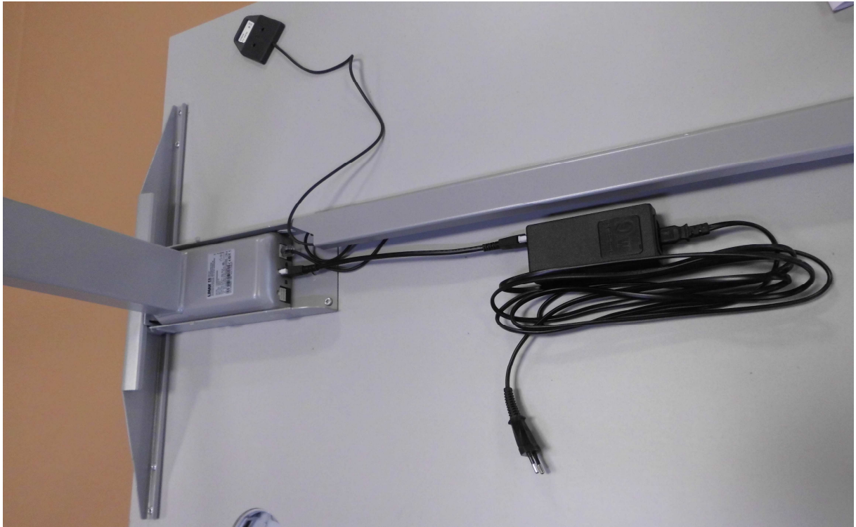
Tischplatte mit Unterkonstruktion und Trafo
